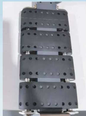
Alimentación de papel por succión neumática + detección ultrasónica de doble hoja y descarte de residuos
