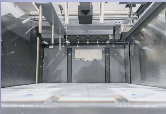
Alimentación de papel por succión neumática + detección ultrasónica de doble hoja y descarte de residuos
