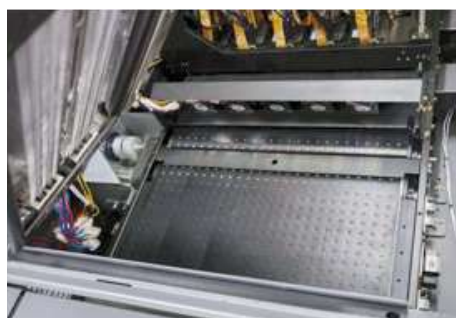
Sistema de secado por radiación térmica infrarroja
