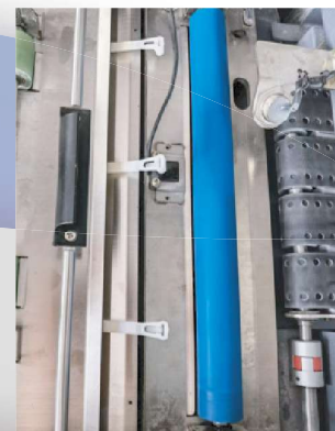
Alimentación de papel por succión neumática + detección ultrasónica de doble hoja y descarte de residuos
