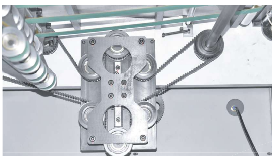
Transmisión por correa dentada del alimentador de papel
